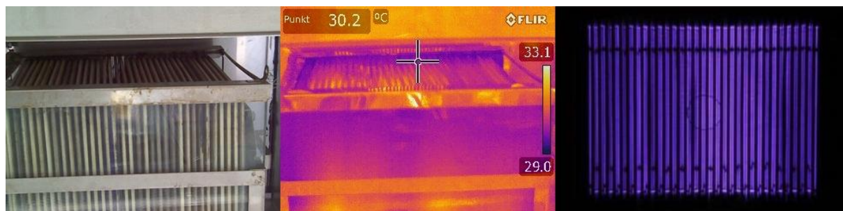
Abb. 2: Nicht-thermisches Plasma – real, als Wärmebild und als Spektrum
