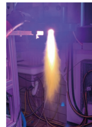
80 kW Plasmabrenner in Betrieb im Labor
