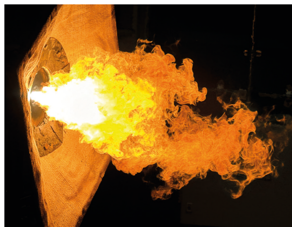
100 kW Hohlkathodenplasmabrenner mit Methan als Plasmagas
