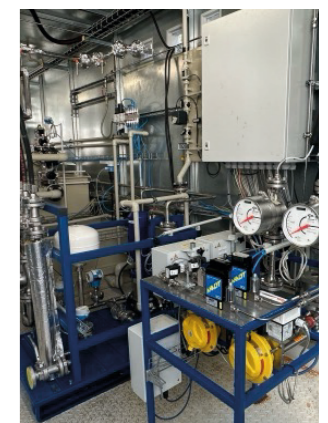
2 x 50 kW FCKW Zersetzung in der chemischen Industrie
